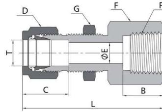
英制管-NPT 内螺纹/Fractional Tube to NPT Thread
